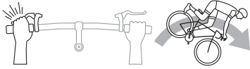
Gb 1.8: Lakukan pengereman bersamaan. Dengan hanya menggunakan rem depan saja membuat sepeda menjadi terbalik.
